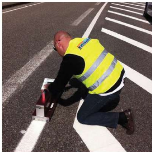
Figura 7.1 – Inspeção estática sobre marcas rodoviárias
