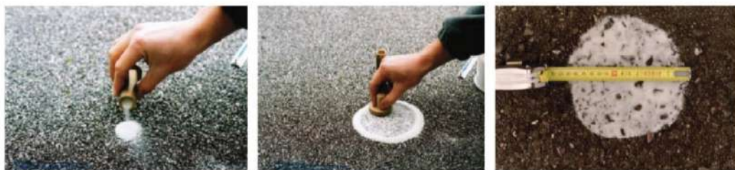
Figura 7.3 – Ensaio da mancha de areia
